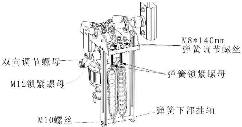
3. 用扳手下卸弹簧下部挂轴的一个 M10 螺丝；如果弹簧是挂钩的，就不用取 M10 的螺丝，直接取出弹簧即可。
